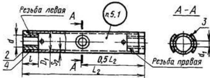
1 - струна; 2 - гайка; 3 - шайба; 4 - труба
